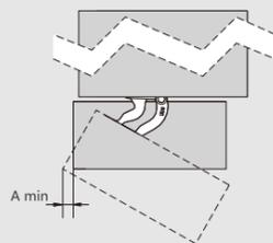
A=门板轨迹避让间隙 K=门板钻孔到门板边沿距离 T=门板厚度
