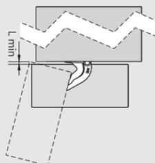
L=门板与柜侧的距离 K=门板钻孔到门板边沿距离 T=门板厚度
